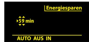
**Energiesparmodus** Das Instrument verwendet stromsparende LED-Lichtquellen und ein batterie-schonendes OLED-Display. Ein Satz Batterien hat eine Lebensdauer von ca. 10.000 Messungen. Um die maximale Lebensdauer der Batterien zu erhalten, ist das Gerät mit einer einstellbaren „automatischen Abschalt-Funktion“ ausgestattet. Diese automatische Abschaltung kann zwischen 1 und 59 Minuten individuell eingestellt werden. Die Stromversorgung erfolgt über zwei AA-Batterien.
