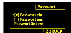
**Passwortgeschützt** Durch ein Passwort können Sie bestimmte Funktionen vor unbefugten Änderungen schützen. Dieser Schutz kann jederzeit aktiviert oder deaktiviert werden. Der Code ist frei programmierbar. Geräteeinstellungen, Limit Änderungen, das Löschen von Messungen sowie das Löschen des Speichers zählen zu den geschützten Anwendungen.
