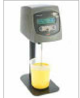
Im Lieferumfang befinden sich die Spindeln R2-R7. Die Spindel R1 kann optional bestellt werden.
