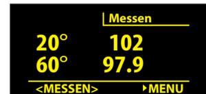
**Scan-Modus** Wird die "Scan-Taste" gedrückt und gehalten, startet das Glanzmessgerät die kontinuierliche Messung mit einer Rate von etwa 70 Messungen pro Minute. Das Gerät speichert diese Messwerte, wenn diese Option im Vorfeld aktiviert wurde.
